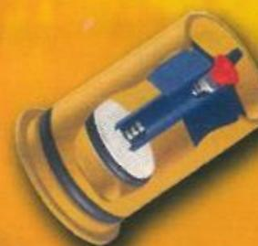
**فیوز گاز** معمولی است مکانیکی که هنگام عبور بیش از مدمجیان گاز را بصورت اتوماتیک قطع می نماید و پس از رفع عیوب شبکه در فشارهای پایین جریان را بصورت اتوماتیک برقرار می نماید. توصیه میگردد در فشارهای بالا وصل مجدد جریان گاز به صورت دستی انجام شود.
