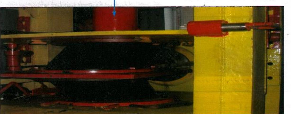
شماره ۷- آزمایش ۲ جداگر لرزه‌ای از پروره‌زاوه تربت ( محل آزمایش: کشور اسلامیان )
